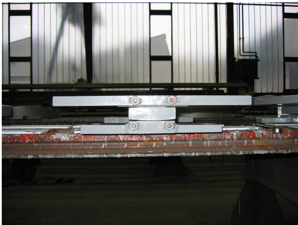
Partie 6 : Appareils d'appui à balancier Exemple d'un appareil d'appui à balancier à contact linéaire
