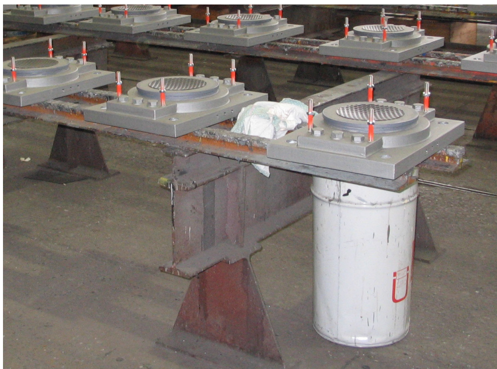
Partie 7 : Appareils d'appui sphériques Exemple d'un appareil d'appui sphérique
